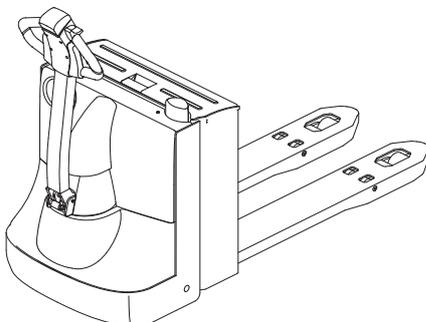
Durch exzellente Manövrierbarkeit und einfache Steuerung eignet sich der WPX20 besonders für Arbeitseinsätze mit schweren Lasten bis zu 2t. Typische Anwendungsfälle sind das Be- und Entladen von Warenlieferungen oder das Auffüllen von Regalen.
