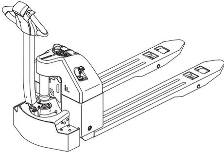
Der WP15 ist das optimale Einstiegsmodell in den Bereich der Niederhubwagen. Ideal für den schnellen Transport über kurze Strecken auf ebenem Boden, und dank kompakter Abmessungen (Breite 560 mm x Länge 12: 470 mm) auch für Einsätze in beengten Platzverhältnissen die richtige Lösung.
